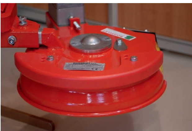
Une large gamme de tondeuses interceps est proposée. La différence se fait souvent au niveau du système d'effacement ou encore sur la vitesse de rotation et donc la qualité de la tonte.
