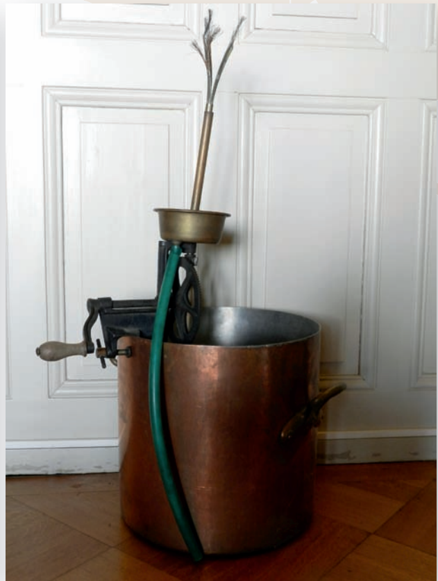
Figure 1.2 : Lave-bouteille : en position de fonctionnement
