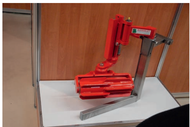
Ce mini Rolofaca pour l'entretien du cavaillon permet d'écraser l'herbe située sous le rang et d'éviter ainsi une repousse trop rapide (voir ci-après).
