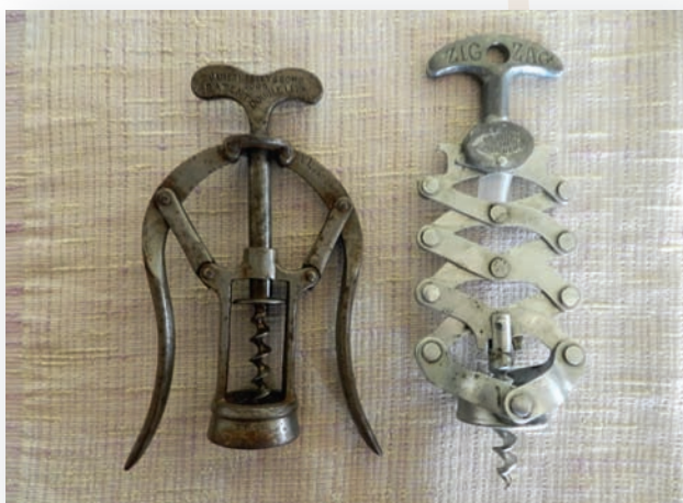
Figure 4.3: Deux tire-bouchons démultipliant la force physique
