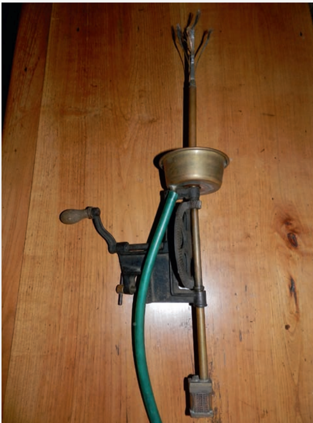
Figure 1.1 : Lave-bouteille ou rince-bouteille : le mécanisme
