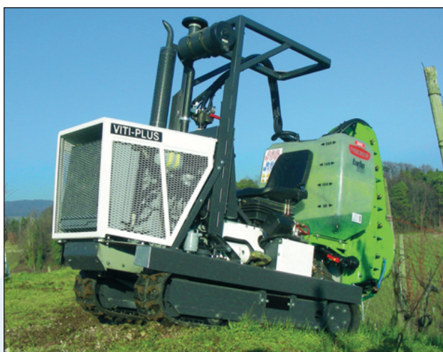
Tracteur Viti-plus équipé d'un sulfateur Portato K1
